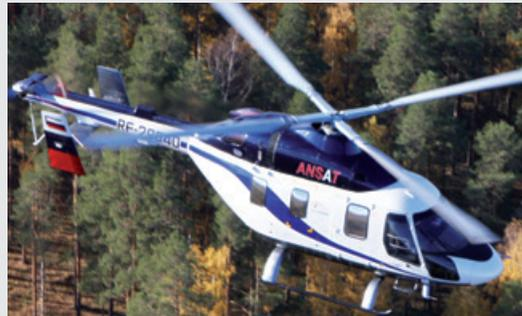
Легкий двухдвигательный многоцелевой вертолет Ансат. С помощью быстросъемного оборудования он может быть оперативно переоснащен для выполнения широкого круга задач: перевозки грузов и пассажиров, наблюдения, поисково-спасательных, противопожарных и медико-эвакуационных работ.
