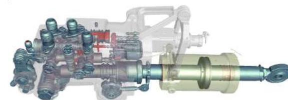
В ходе исследования дополнительно было выполнено разделение агрегата на материалы (алюминиевые сплавы, сталь и др.), исследование положения распределительных окон золотников, а также, для облегчения восстановления гидравлической схемы, выделение каналов рабочей жидкости отдельным цветом.
