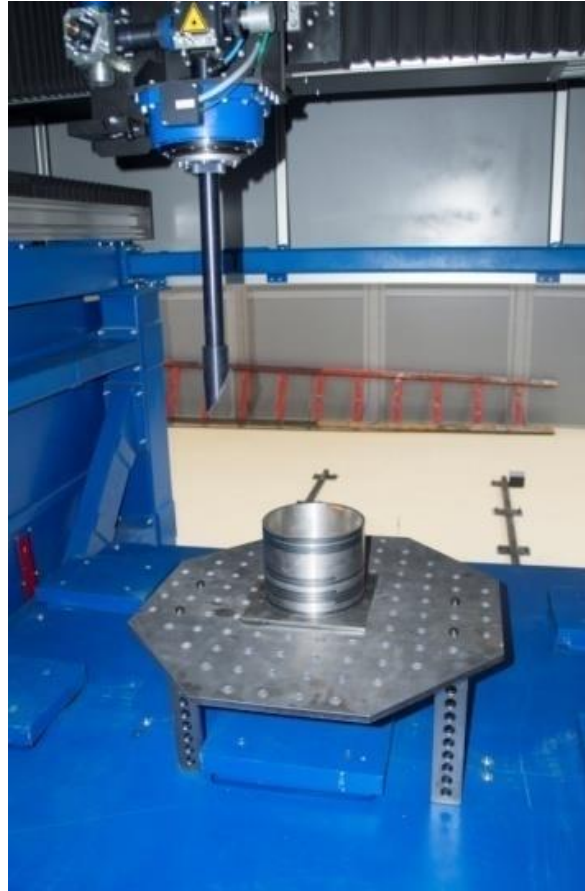
Пример изделия, полученного при помощи модуля лазерного упрочнения
